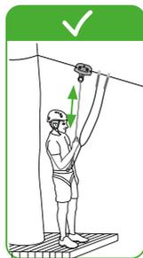
Tyrolienne  $\geq 300$  m : Utiliser C-ZIP XTREM ou LOCK XTREM (avec porte-connecteurs) pour éviter le frottement des connecteurs sur le câble / Zipline  $\geq 300$  m : Use C-ZIP XTREM/LOCK XTREM (with connector holder) to avoid connector friction on the cable
